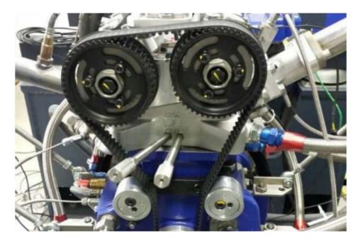
Após 14 anos de estudo, pesquisadores da Universidade Federal de Minas Gerais (UFMG) desenvolveram motor movido a etanol com eficiência igual a do diesel e consumo de combustível inferior ao da gasolina. Tecnologia pode ser adaptada a automóveis de pequeno e grande portes.
