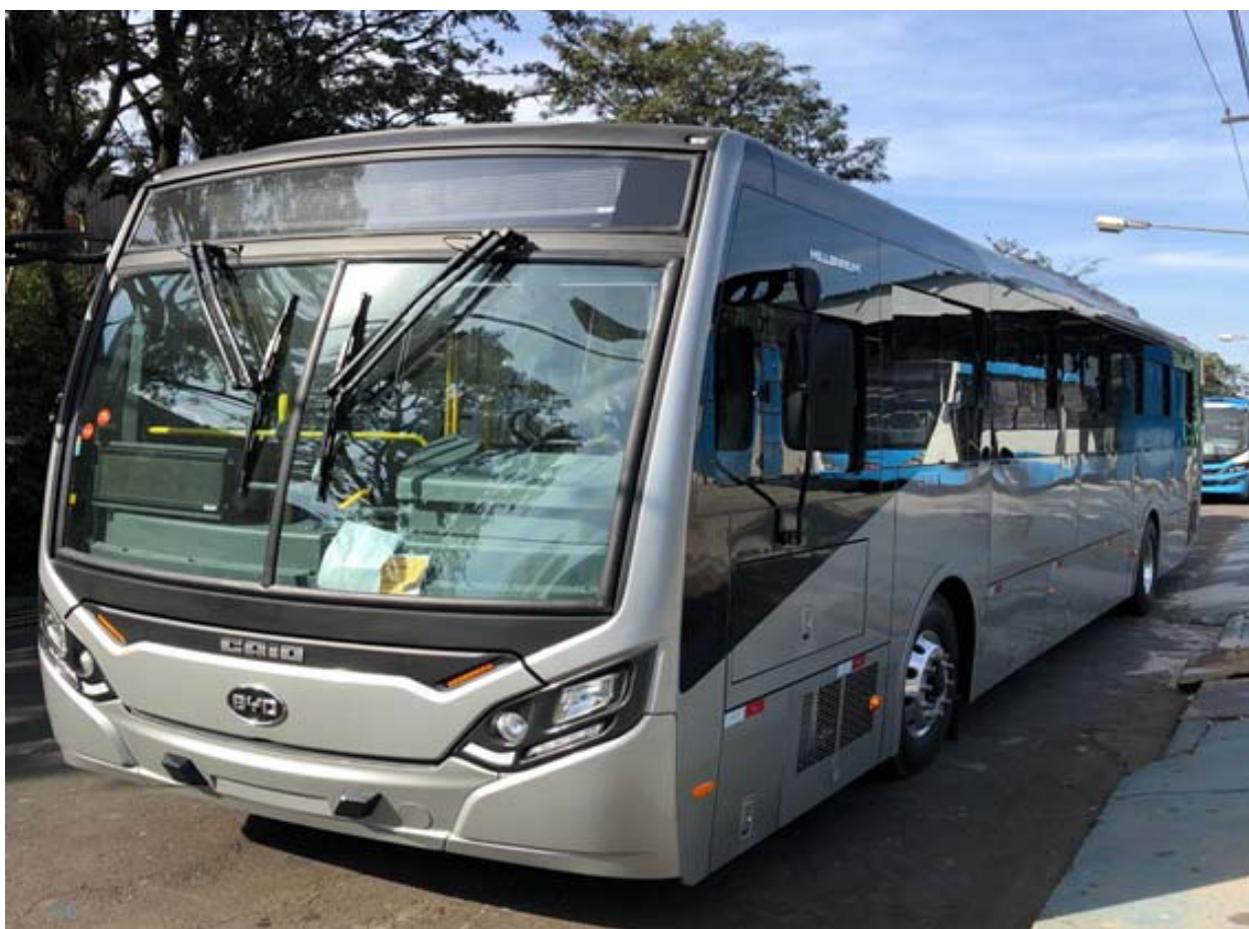
Os dois motores elétricos são acoplados às rodas. Cada um tem potência de 150 kW (equivalente a 203,9 cv), que nos dois eixos somam 300 kW (407,8 cv).
